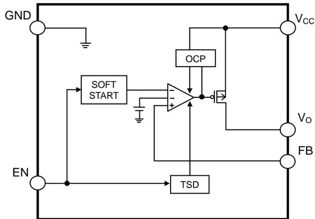
Fig.1 ブロック図 (可変出力タイプ)
