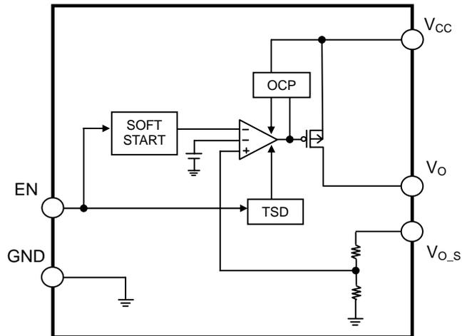
Fig.2 ブロック図 (固定出力タイプ)
