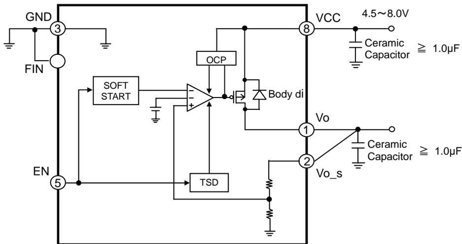
Figure 2. ブロック図 (固定出力タイプ)
