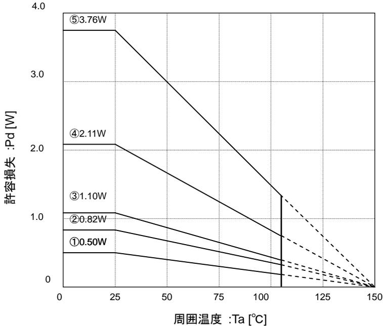
測定状態：ローム基板実装、及び IC 単体
