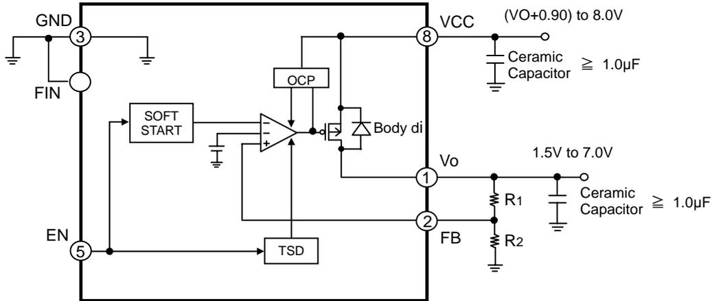
Figure 1. ブロック図 (可変出力タイプ)
